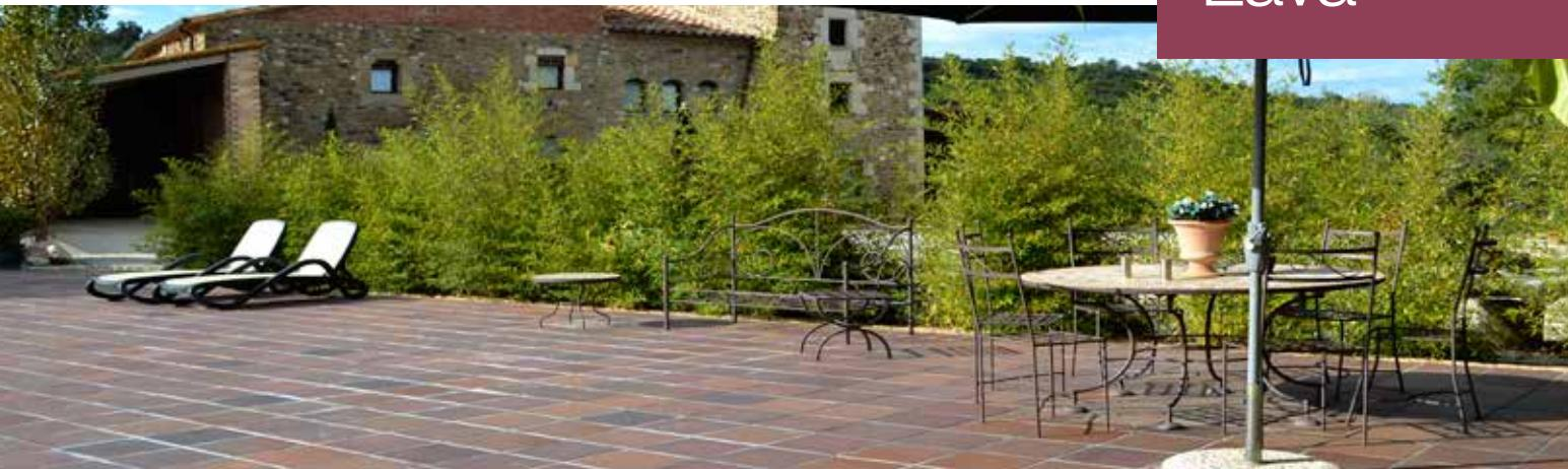
**LAVA** – это высококачественный экструдированный клинкер, обладающий отличными техническими характеристиками по прочности и долговечности. Земля, вода, огонь и воздух являются единственными компонентами, которые применяются в производственном процессе. Полученная из смеси глин паста (без добавления флюса) экструдируется и затем запекается в печах прерывистого цикла в течение более 40 часов.
